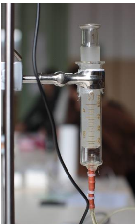
Figura n° X: Siringa in vetro montata alla struttura portante, si nota come il connettore sia stato attaccato al beccuccio con una guaina in gomma e delle fascette
