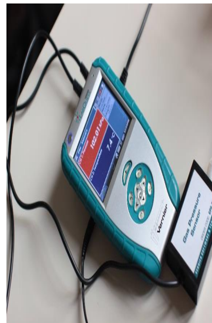
Figura n°2: Sensore di pressione e dispositivo per la raccolta dati.
