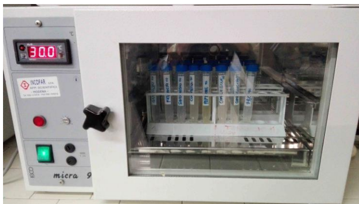
Fig.3 Incubazione delle colture di S. cerevisiae a 30°C
