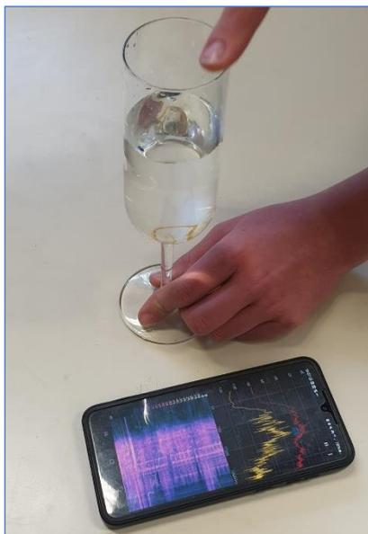
Figura 6 Apparato sperimentale per la misura del suono emesso da un bicchiere
