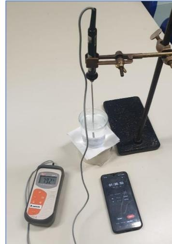
Figura 20 Apparato sperimentale per il rilevamento della temperatura di un liquido che si raffredda.
