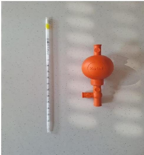
In figura: pipetta graduata da 2 mL e palla di Peleo
