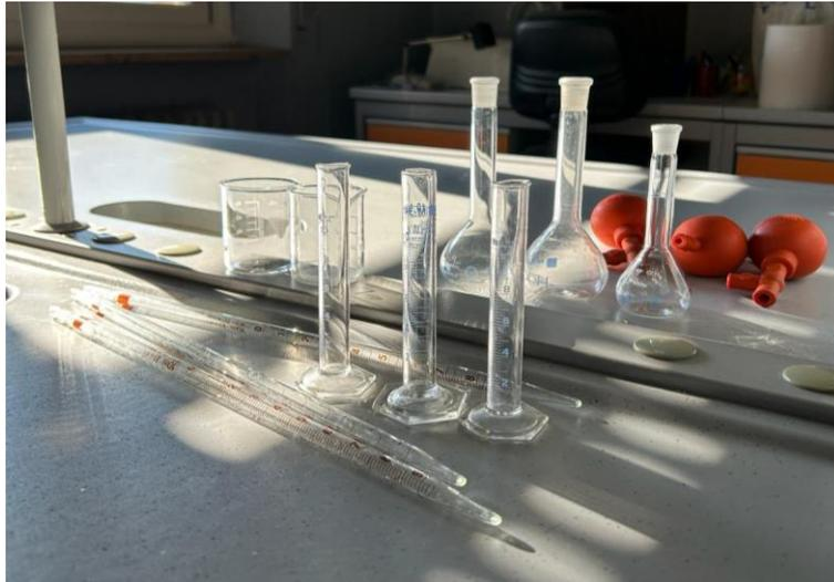
In figura: cilindri graduati, pipette graduate, matracci e palle di Peleo
