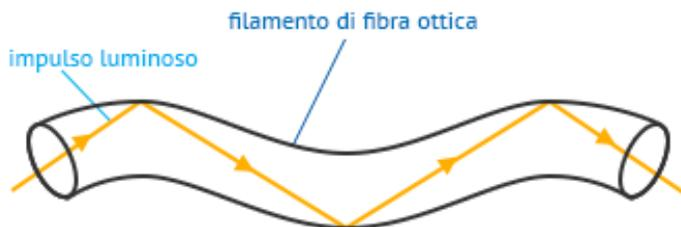
Una fibra ottica funziona come se fosse uno "specchio tubolare" dove il raggio luminoso rimane "intrappolato", per riflessione totale, per tutta la sua lunghezza, senza alcuna dispersione di energia luminosa. Le fibre ottiche sono composte da un nucleo cilindrico generalmente di fibra di
