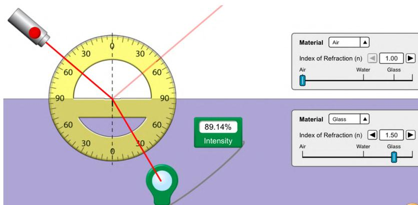
In questa prima figura il raggio incide dall'aria all'acqua, in parte (10,86%) viene riflesso con un angolo congruente all'angolo di incidenza (50°) e la parte restante (89,14%) viene rifratta con un angolo minore di quello di incidenza (30°) essendo  $n_1 < n_2$ . Il raggio rifratto si avvicina alla normale.
