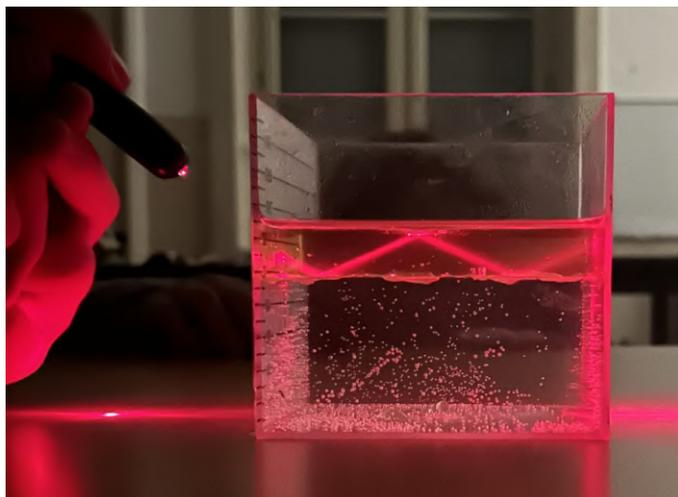
**Procedimento:** Versare nel contenitore dell'acqua e poi sopra uno strato di 2-3 centimetri di olio. Mettere il contenitore in un locale al buio. Accendere il laser e trovare l'angolo in cui il laser passa per lo strato d'olio e rimbalza creando uno "zig-zag" nell'olio. Dopo aver trovato l'angolazione giusta, spargere il talco alla traiettoria dell'uscita del contenitore, in modo da poter osservare la luce che esce dall'olio.
