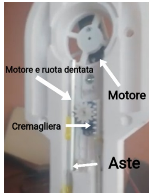
Fig.12 Primo prototipo motorizzato per inclinare i piedi
