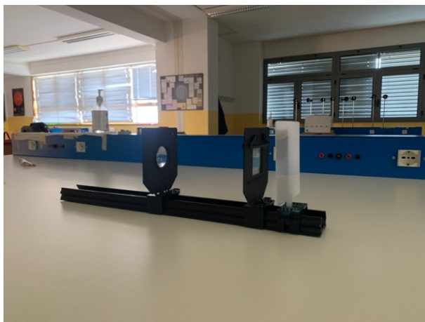
A: Lente convergente B: Reticolo di diffrazione C: schermo
