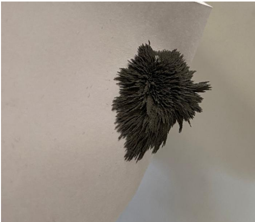
Fig.9: visualizzazione delle linee di campo mediante limatura di ferro; sinistra il magnete in posizione inclinata, a destra in posizione orizzontale
