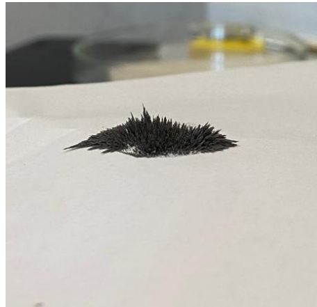
Fig.9: visualizzazione delle linee di campo mediante limatura di ferro; sinistra il magnete in posizione inclinata, a destra in posizione orizzontale
