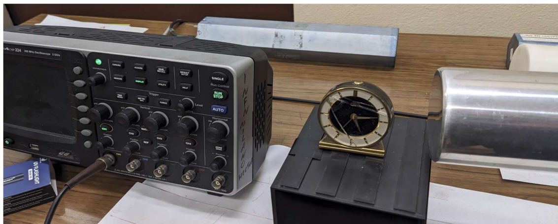
Sveglietta in prossimità del rivelatore gamma HPGe e sistema di acquisizione multicanale.
