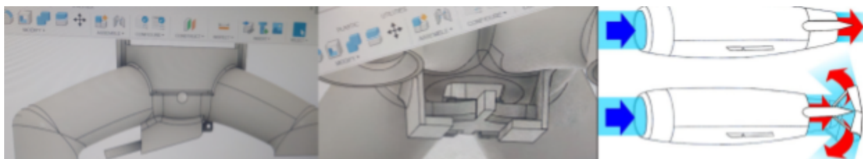
Fig. 25 Meccanismo per modalità auto e inversore di spinta aeronautico
