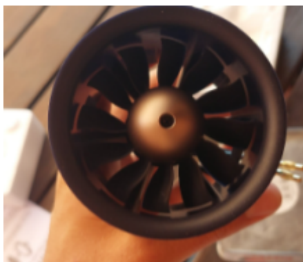
Fig. 12 Ducted fan da 70 mm
