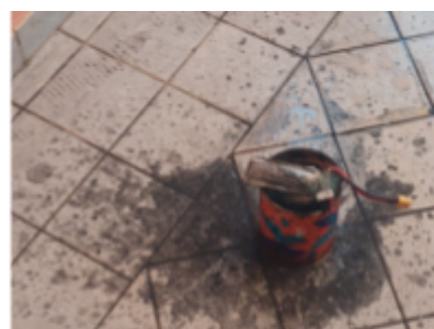
Fig. 13 La batteria subito dopo l'incidente
