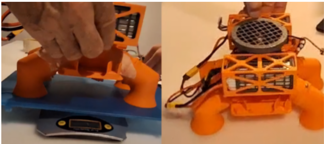
Fig. 29 Test di spinta eseguiti sulla bilancia e test di sollevamento
