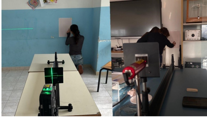
Figura 15: Immagine dell'apparato sperimentale per l'esperimento di Young
