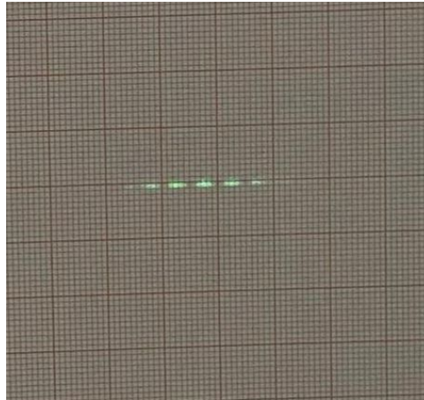
Figura 17: Figura di interferenza ottenuta con il laser verde
